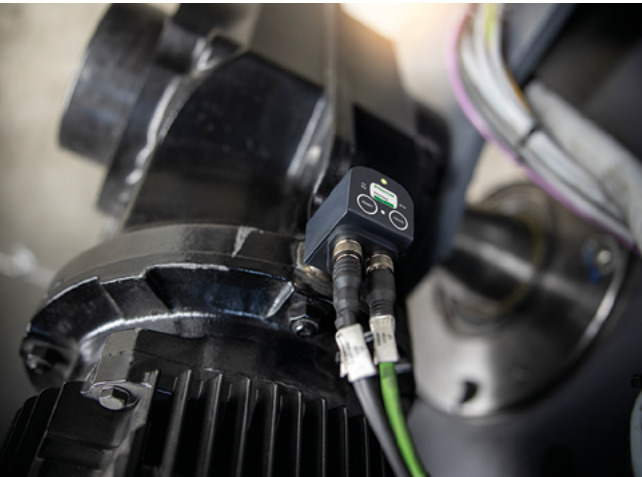
Állapotfelügyeleti megoldás Papírgyár: Az OPTIME CM jól teljesít a motorfelügyeletben
