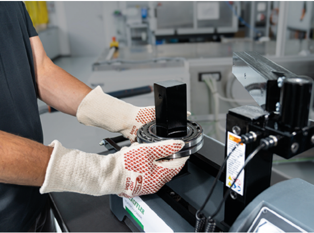
Ipari szerszámok – Összeszerelés Ipar: a HEATER-ek a kíméletes induktív fűtés révén megakadályozzák az olyan sérüléseket, mint az egyenetlen fűtés, a törések vagy a kopásnyomok.
