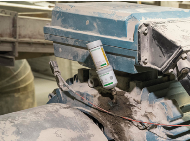
Kenési megoldás Cement ipar: Az OPTIME C1 hajszálpontosan ken, és az intelligens technológiának köszönhetően mindig jelzi az állapotot a (mobil) felhasználói berendezésen, függetlenül a helytől.
